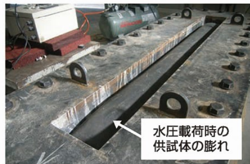
耐水圧試験(RN-U型)
