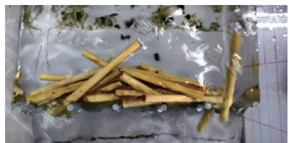
流木で閉塞され排砂、排水しにくい
