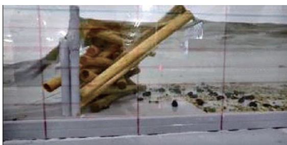
流木で閉塞され排砂、排水しにくい
