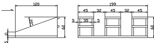
図-1 スクリーン型流木捕捉工の形状(単位:mm)
