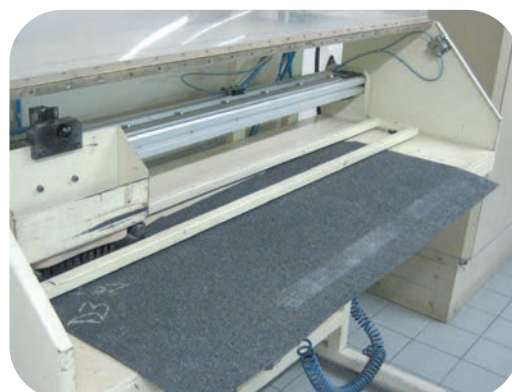
【セラミックグラニュール脱落確認試験の状況】
