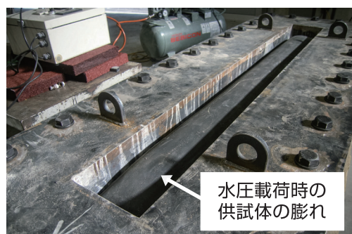
耐水圧試験（RN-U型）
