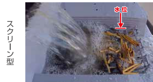
流木捕捉に伴う堰上げ抑制効果
