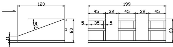
図-1 スクリーン型流木捕捉工の形状(単位:mm)
