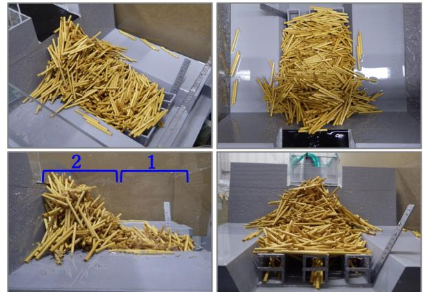
写真-3 流木捕捉状況 (1013本捕捉後)
