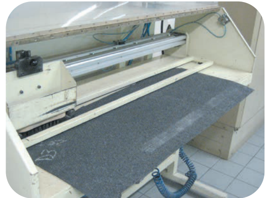
【セラミックグラニューール脱落確認試験の状況】
